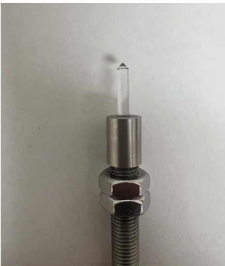
Prisma de Vidrio en el extremo del cable
