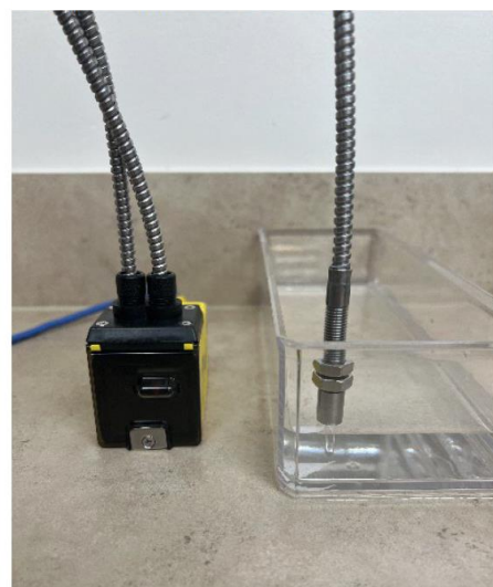
Figura 12-1: Componentes y funcionamiento del sensor de detección de líquidos
