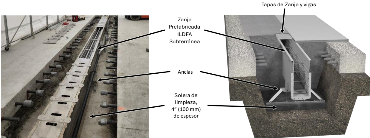
Figura 6-6: Zanja prefabricada ILDFA para proyectos de reacondicionamiento
