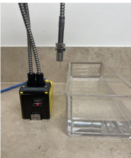
Figura 12-1: Componentes y funcionamiento del sensor de detección de líquidos
