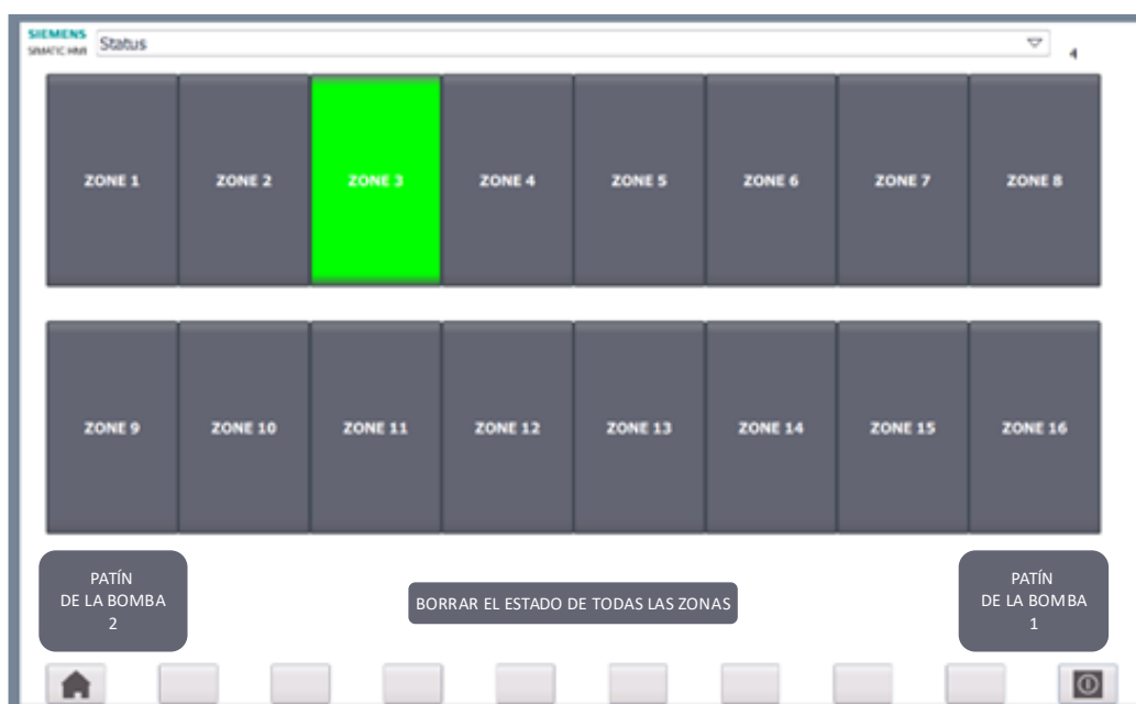
Figura 11-2: Ejemplo de la HMI del ILDFA con el modo de limpieza de la Zona 3 activado
