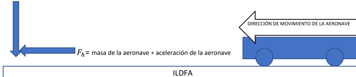
Figura 7-5: Diagrama de cuerpo libre que muestra las fuerzas sobre el ILDFA bajo una aeronave en movimiento
