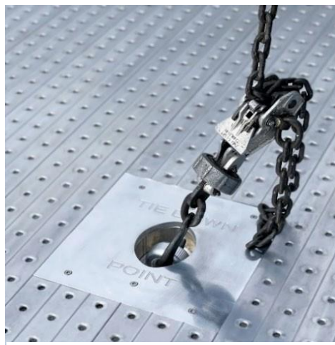
Figure 8-4 : Exemple de point d'arrimage ILDFA avec connexion de chaîne d'aéronef
