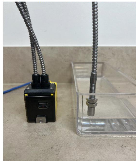
Figure 12-1 : Composants et fonctionnement du capteur de détection de liquide
