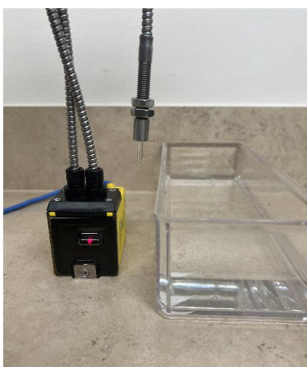
Figure 12-1 : Composants et fonctionnement du capteur de détection de liquide
