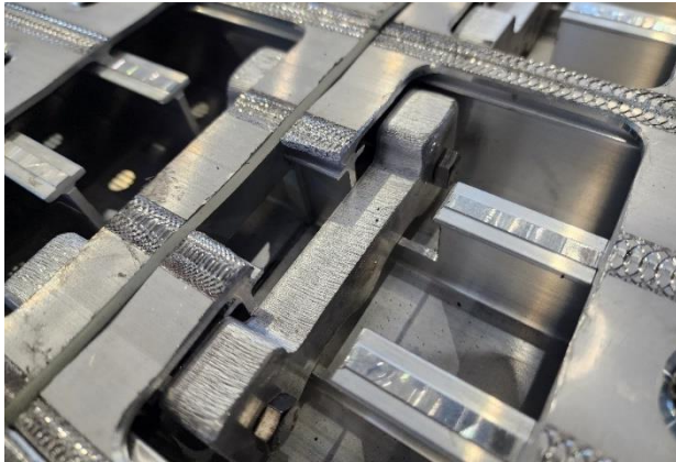
Figure 4-5 : Connexion bout-à-bout du profil — vue rapprochée.
